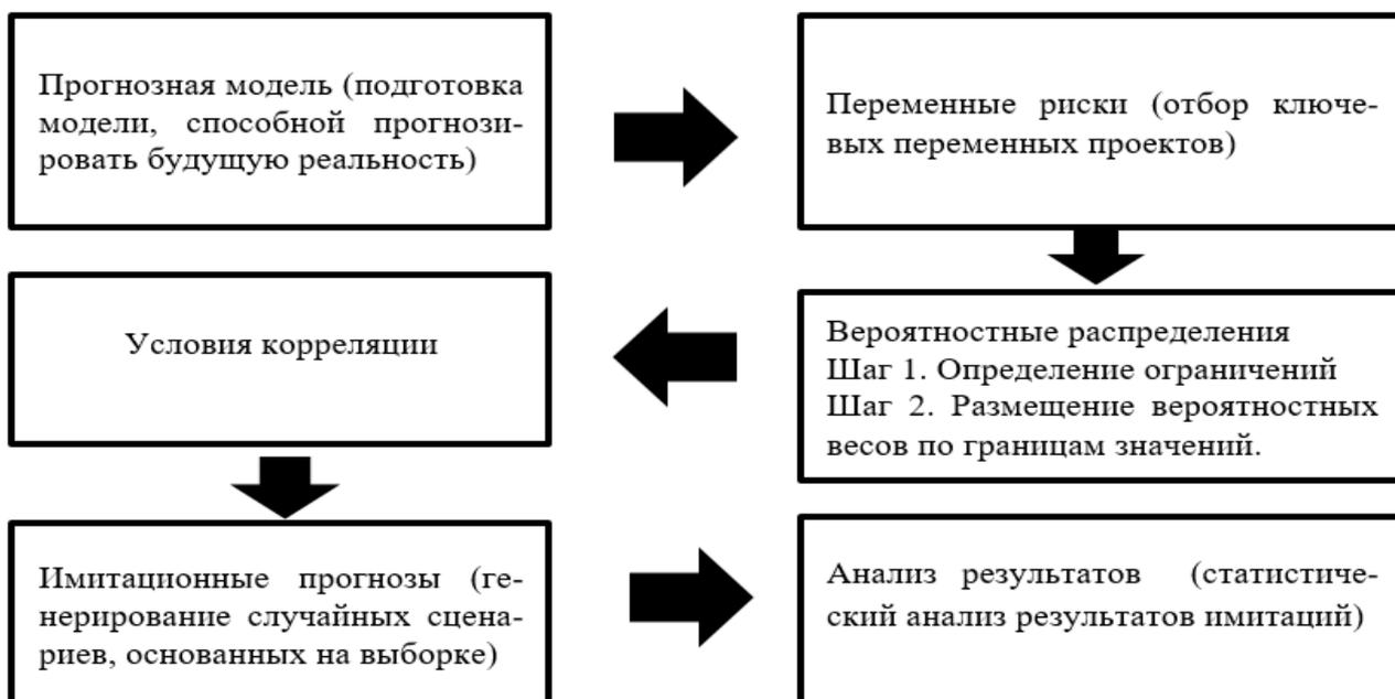
Рис. 2. Блок-схема работы имитационной модели
