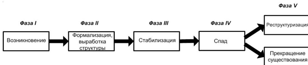
Рис. 2. Фазы жизнедеятельности объектов АКУ (фаза I – этап возникновения – «зарождение, возникновение, появление, проектирование»; фаза II – этап формализации и выработки структуры – «становление, рост, подъем, изготовление»; фаза III – этап стабилизации – «зрелость, высшая точка, равновесное функционирование»; фаза IV – этап упадка – «спад, стагнация, рост отказов, неполадок»; фаза V – этап перестройки – «реорганизация или прекращение существования»)
